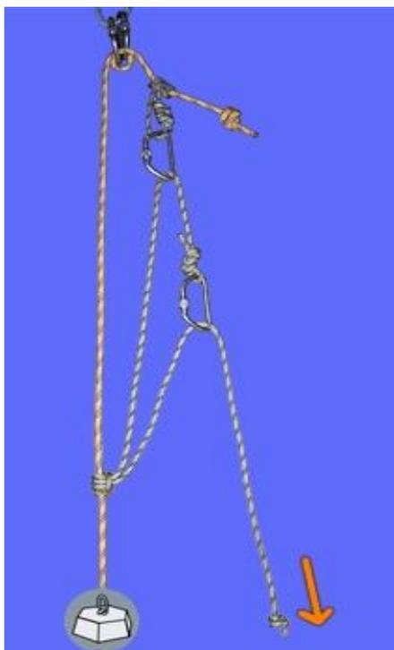
а также для подъёма пострадавшего (например, провалившегося в трещину). Используется система, как правило, из двух схватывающих узлов или механических зажимов, например жумаров. В промышленном альпинизме этот же принцип используется в такелажных работах при подъёме конструкций.
