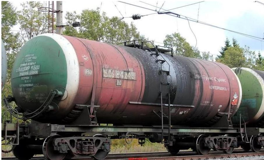
Рис. 1. Цистерна для вязких нефтепродуктов модели 15-1210-01
