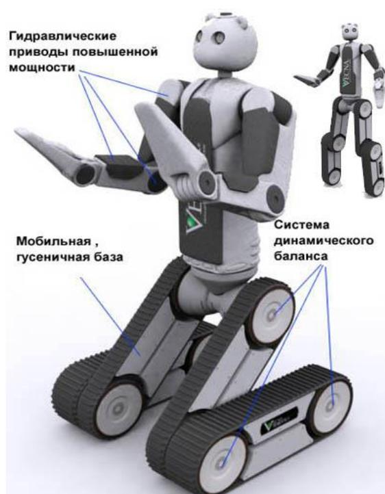
Рис. 1. Робот – эвакуатор раненых солдат [5]
