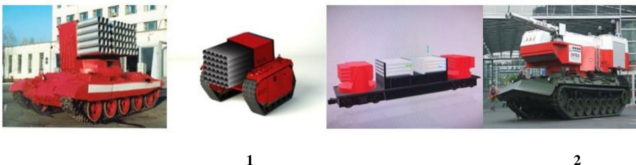
Рис. 2. 1 – ГБПМ «Импульс-3М» с башенной ММ-50, эскизы ММ на работе и железнодорожной платформе; 2 – Немецкая пневмоимпульсная ММ-2 на шасси танка «Леопард-1» содержит также 10-тонную цистерну с водой, компрессор высокого давления
