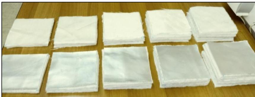
Рис. 2. Комплекты материалов толщиной  $\delta = 8, 16, 24, 32$  и  $40$  мм
