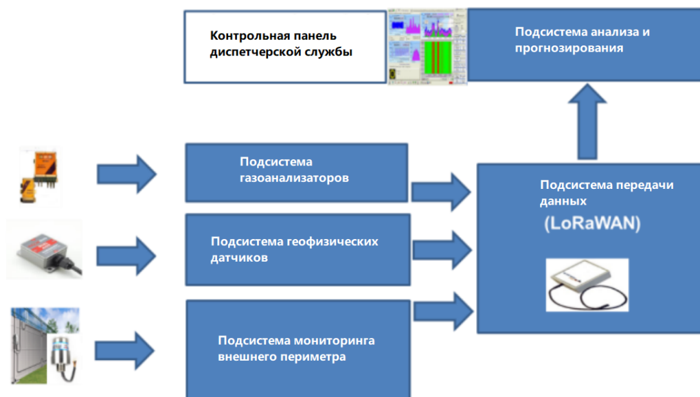
Рис. 1. Блок-схема работы КСМ [13]
