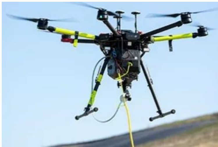
Рис. 8. БПЛА SnifferDRONE, оснащенный детектором метана [23]
