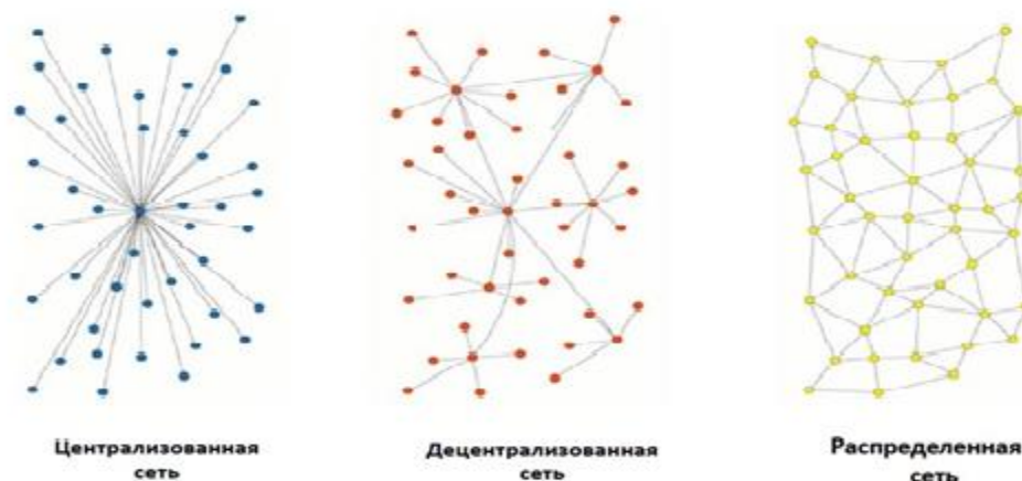
Рис. Основной принцип технологии блокчейн – распределенная сеть
