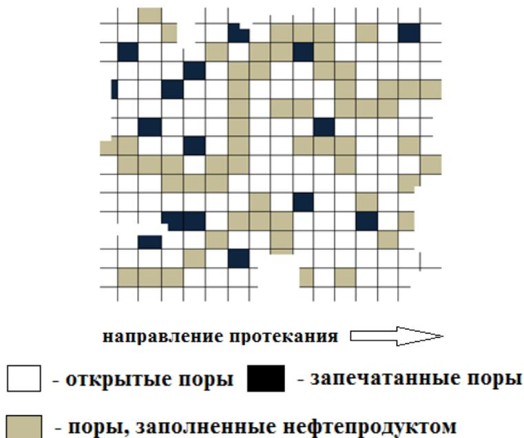
**Рис. 3. Пористая структура в виде двумерной решетки, в которой появляется один проводящий кластер через открытые поры в направлении протекания**
