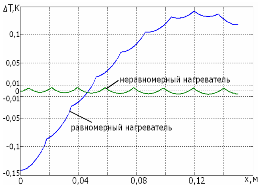
Рис. 4. Распределение температуры по поверхности вертикальной медной пластины толщиной 1 мм
