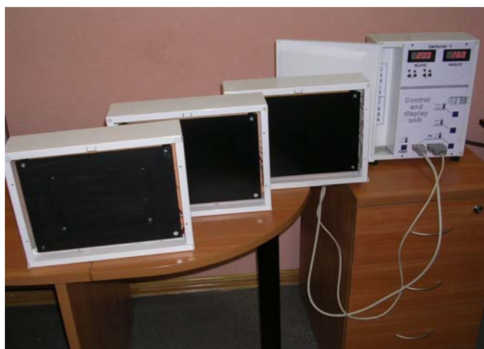
Рис. 7. Комплект оборудования для калибровки тепловизора
