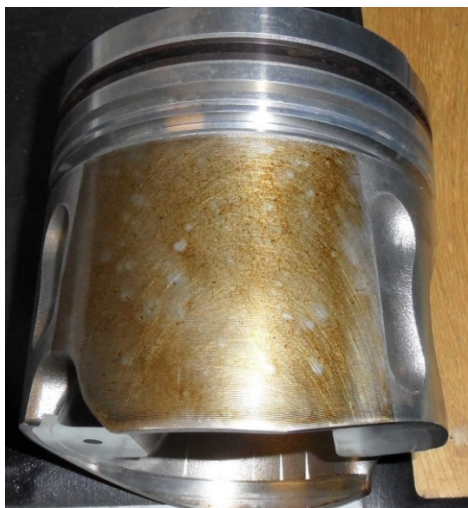
Рис. 3. Поршень с антифрикционным покрытием на базе дихалькогенидов вольфрама (по окончании длительных испытаний)
