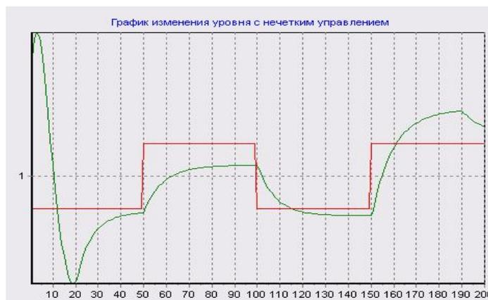
Рис. 5. Переходный процесс при  $H_0=1,5$  м и  $H_z$ =от 0,8 м до 1,2 м
