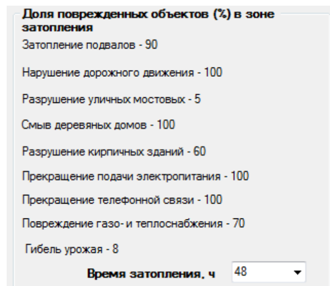
Рис. 9. Доля поврежденных объектов в зоне затопления за 48 ч
