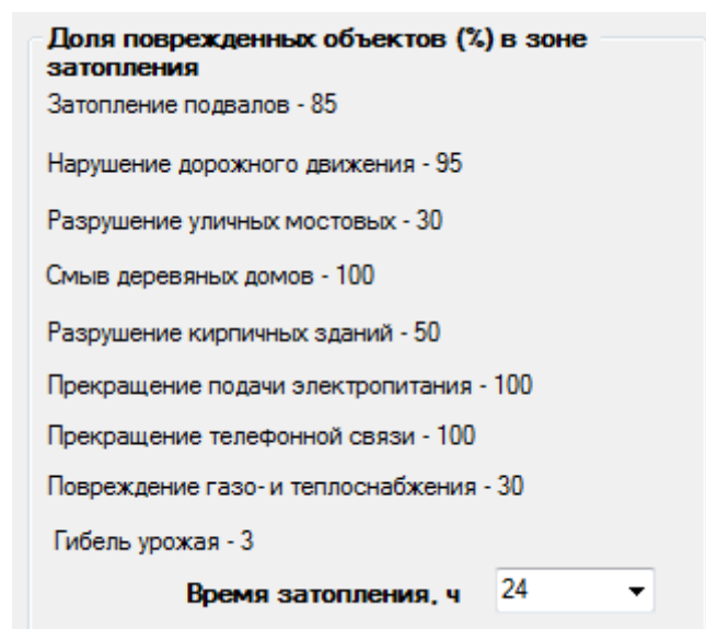
Рис. 8. Доля поврежденных объектов в зоне затопления за 24 ч
