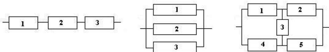
Рис. 3. Схема соединения элементов системы
