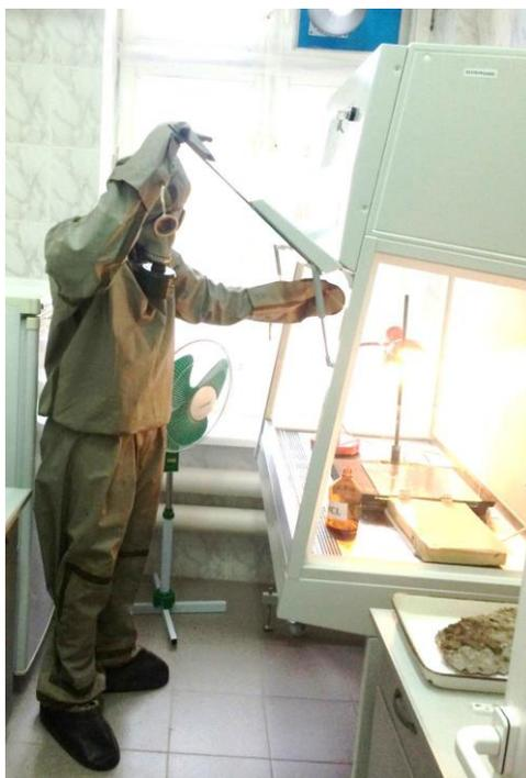
Рис. 3. Экипировка сотрудника, работающего на установке с АХОВ
