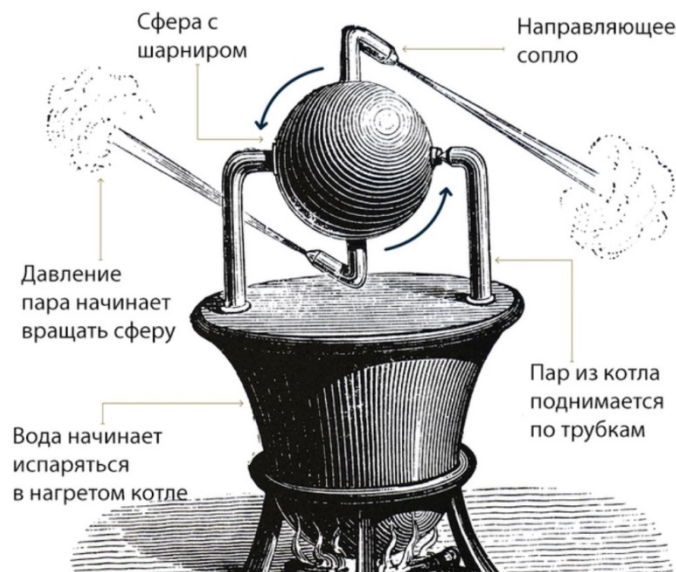
Реактивный паровой двигатель Герона «Ветряной шар»
