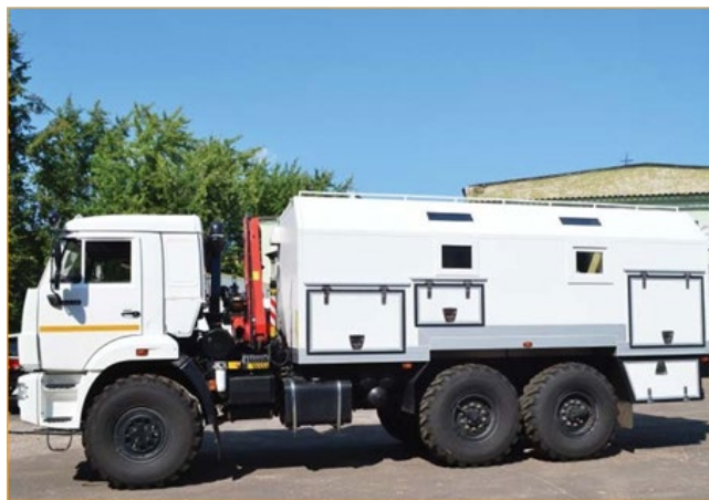
Рис. 1. Мастерская ТО и ремонта
