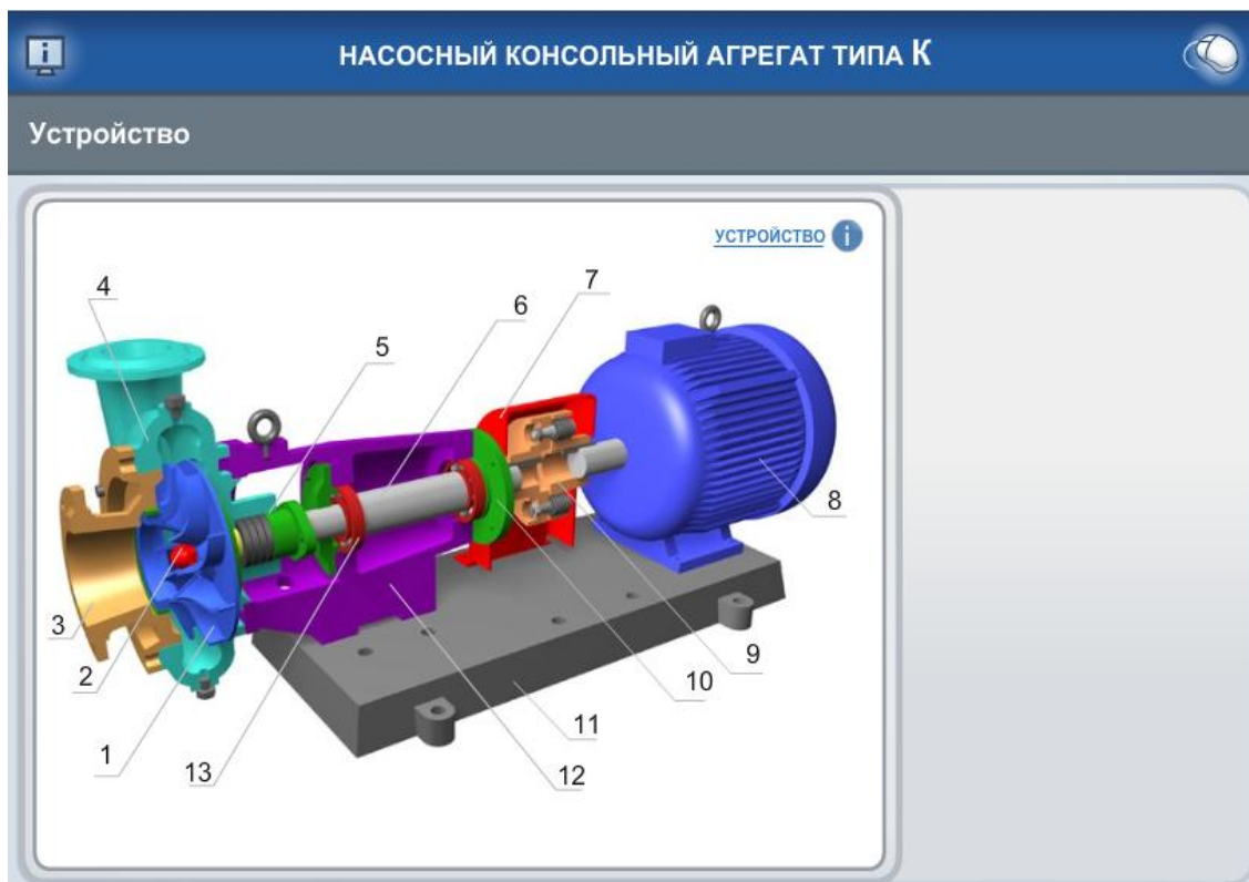
Рис. 3. Объемное изображение насоса с разрезом
