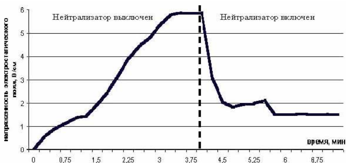
Рис. 9. Динамика изменения напряженности электрического поля, создаваемого пневмотранспортом с пенополистиролом
