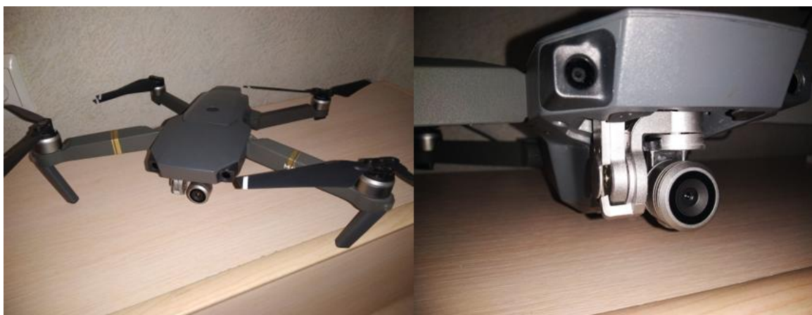
Рис. 4. Общий вид БПЛА и трехосевого подвеса
