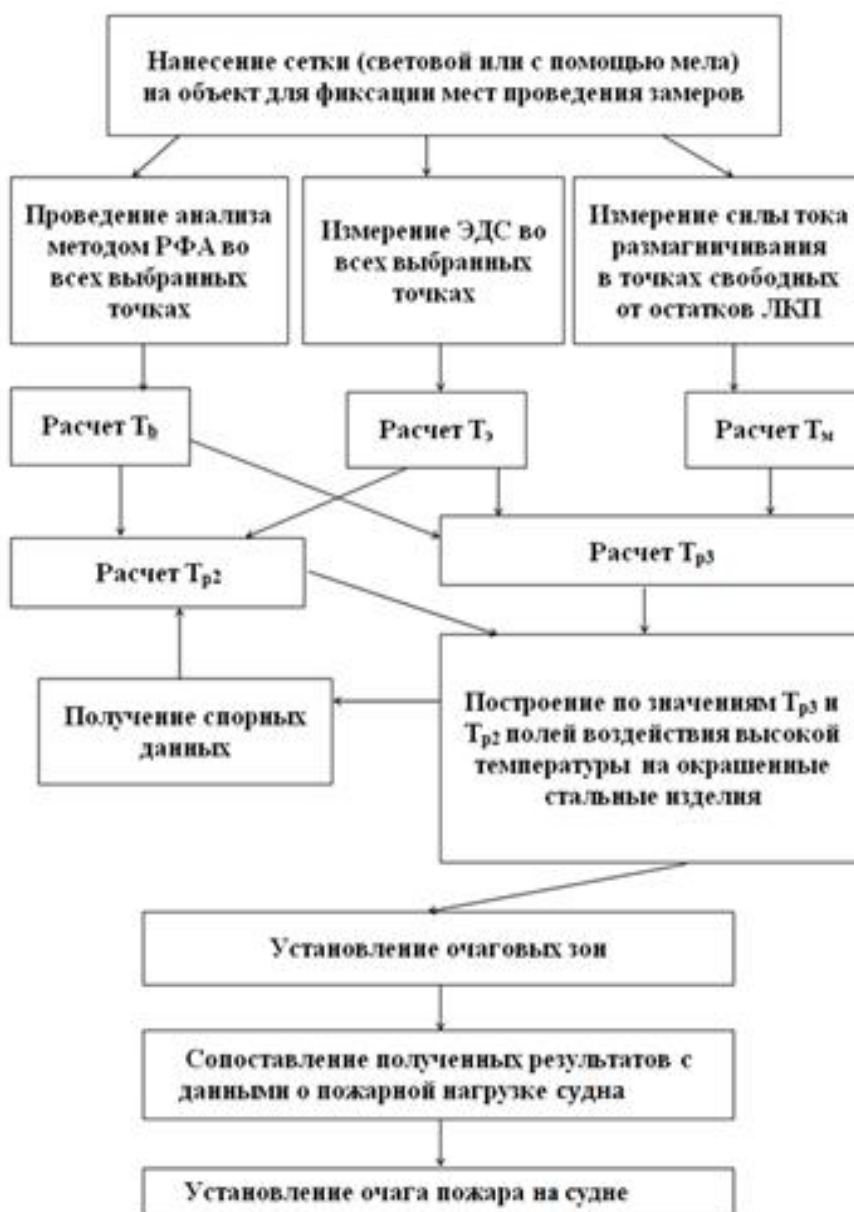
Рис. 1. Схема анализа, объединяющая различные полевые методы исследования, с целью установления очага пожара на маломерном судне
