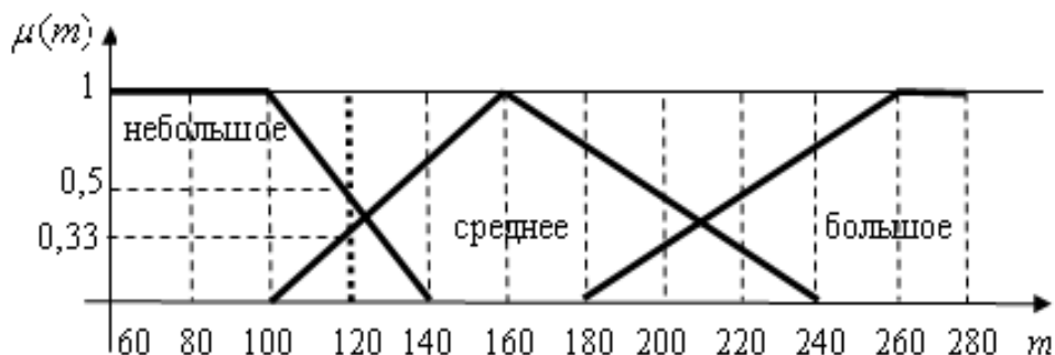
Рис. 4. Графики функций принадлежности термов переменной «число человек, проживающих в здании»
