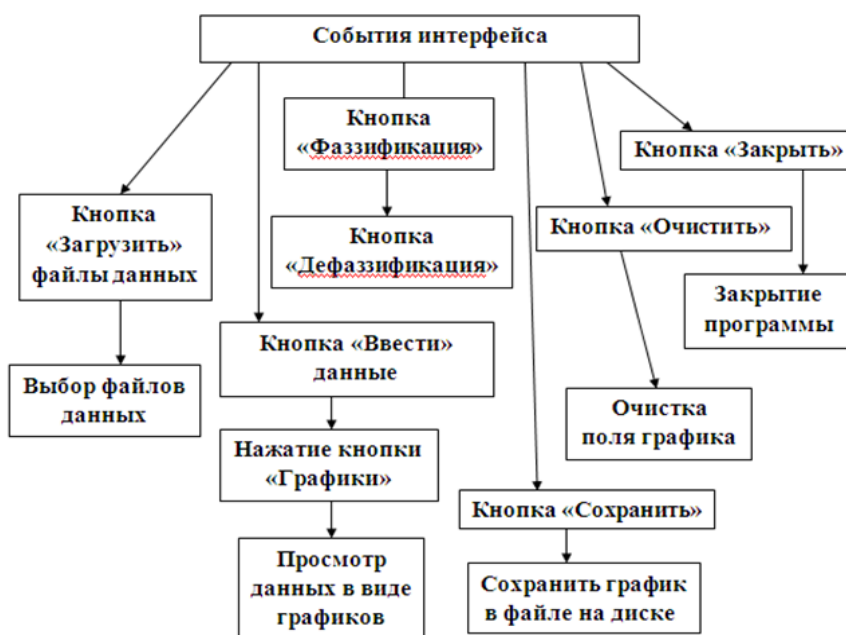
Рис. 4. Укрупненная схема обработки событий в программе для ЭВМ
