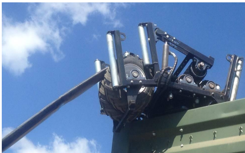
Рис. 3. ЗУ, установленное на борт контейнера
