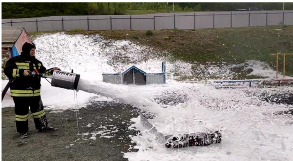
Рис. 5. Подача пены после обработки воды в течении 60 мин
