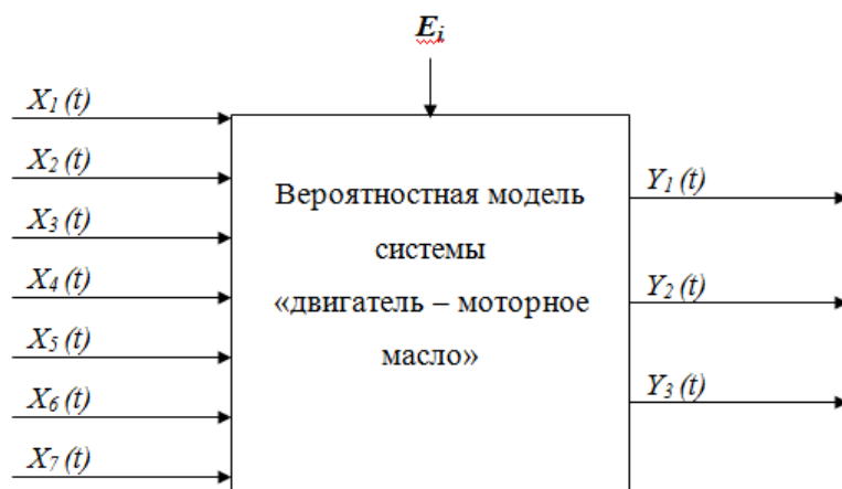
Рис. 1. Схема воздействия эксплуатационных факторов на изменение показателей физико-химических свойств масла
