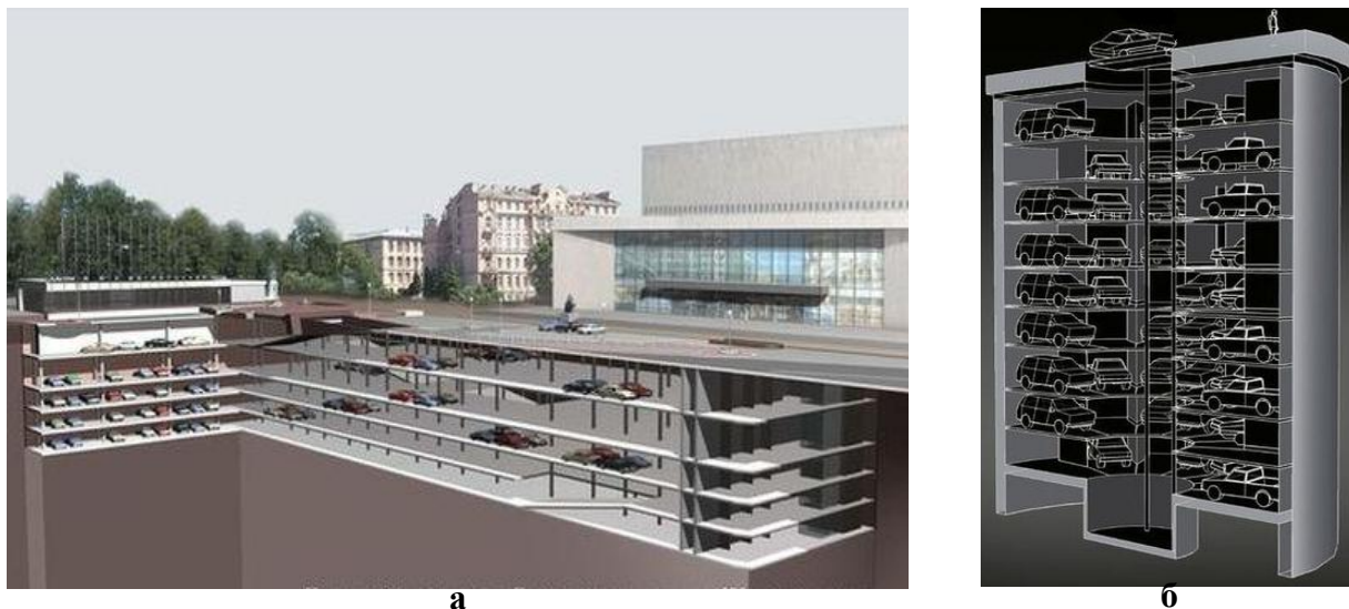
Рис. 1. Примеры подземных автостоянок: а – классическая рамповая; б – автоматизированная цилиндрическая лифтовая карусельного типа
