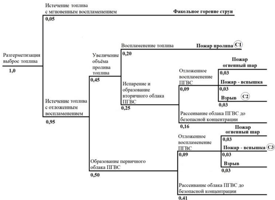
Рис. 3. Дерево событий при возникновении расчетной аварии в резервуарном парке
