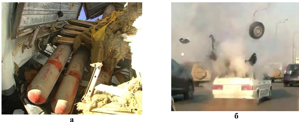
Рис. 2. Взрывы автомобильных газовых баллонов: а – под кузовом; б – в багажнике
