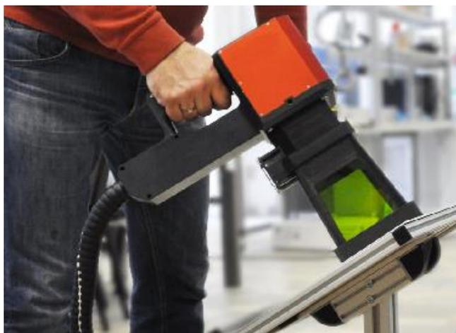
Рис. 1. Нанесение штрих-кода лазерным гравером на металлосоержащее изделие
