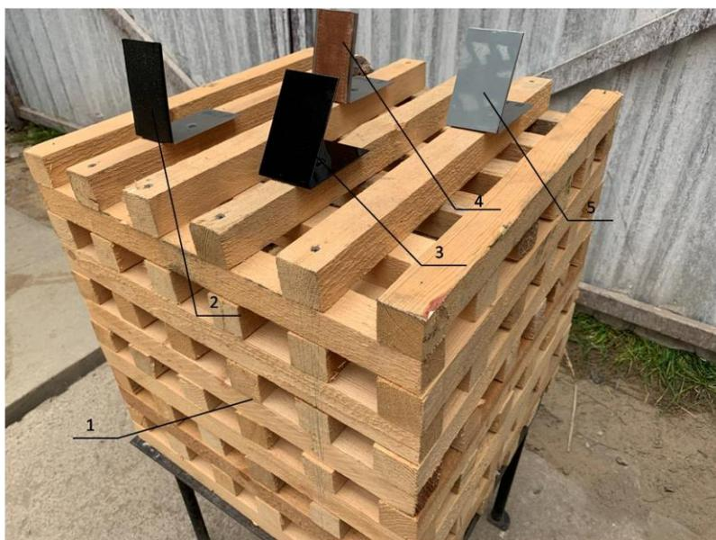
Рис. 2. Образцы твердых горючих материалов, закрепленные на модельном очаге пожара ранга 1А: 1 – модельный очаг пожара 1А; 2 – образец из резины; 3 – образец из окрашенной стали; 4 – образец из натуральной кожи; 5 – образец из пластика
