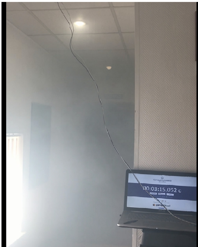
Рис. 3. Задымление путей эвакуации
