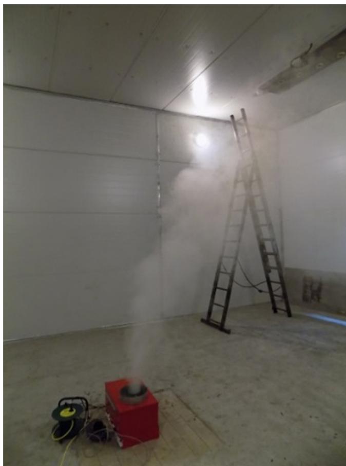
Рис. 7. Работа имитатора тестового очага пожара «Кипарис»
