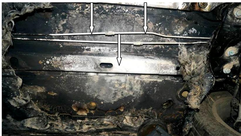
**Рис. 1. Под полностью выгоревшей антикоррозионной обшивкой днища кузова ТС Skoda Yeti 1.2 TSI [6] со стороны КН (показано стрелками) – отожжены левый лонжерон и две тормозные магистрали (трубки)**
