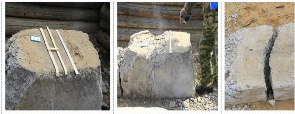
Рис. 6. Перебитие бетонного блока толщиной 520 мм с помощью БЛЗ
