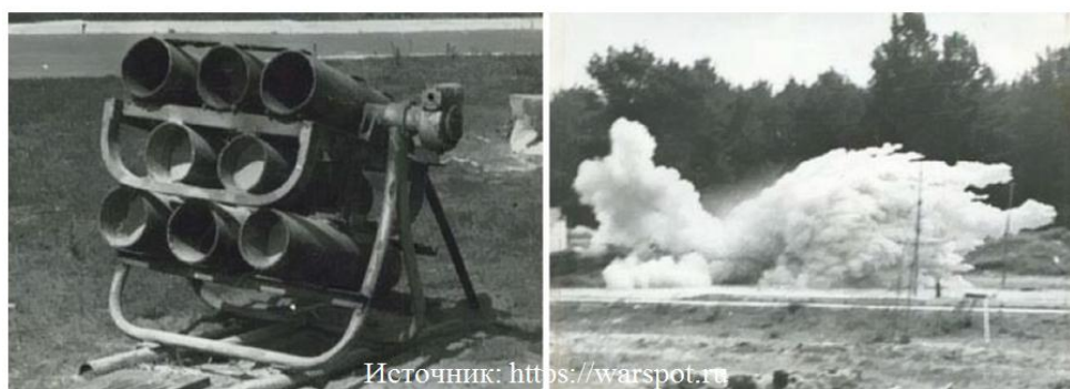
Рис. 2. Многоствольный пожарный модуль на полозьях конструкции В.Д. Захматова, 1981 г.
