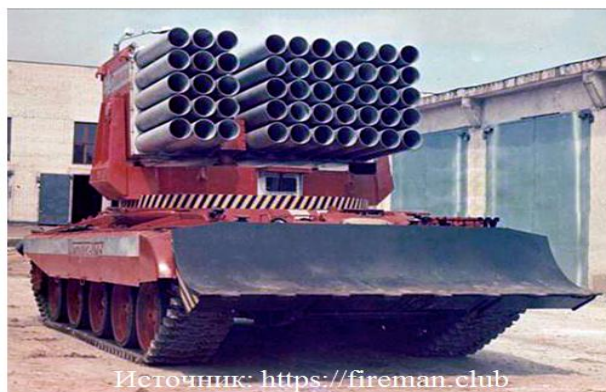
Рис. 5. Машина «Импульс-2» с бульдозерным отвалом БТУ-55
