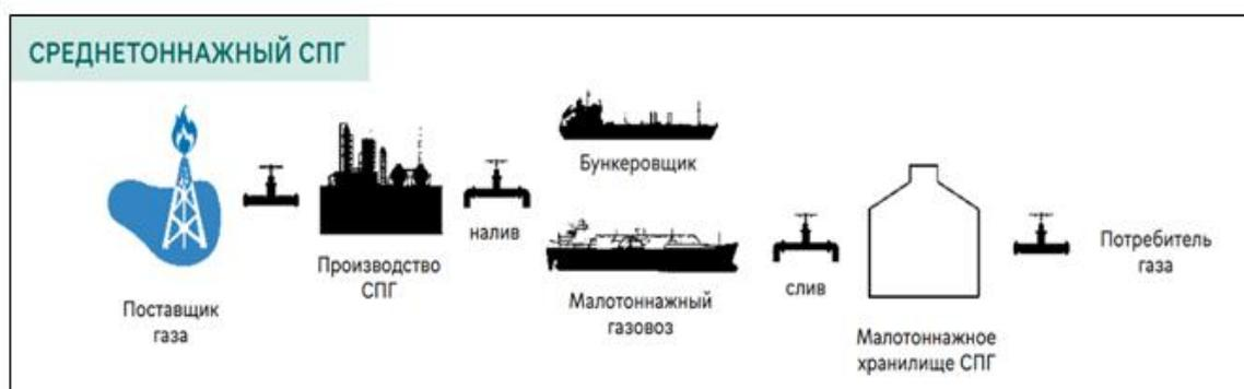
Рис. 2. Схема технологических операций среднетоннажного производства СПГ
