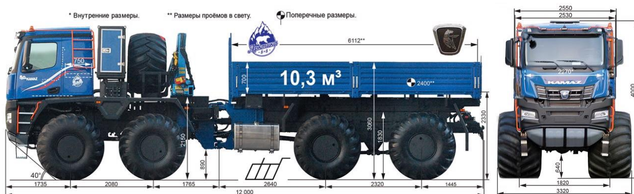
Рис. 9. Габаритные размеры шасси КамАЗ-6355 (8х8) «Артика»
