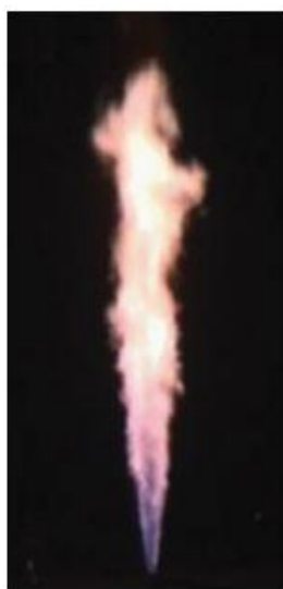
Рис. 1. Фотография видимого пламени водорода (слева) и его длина L в зависимости от времени (справа) [25]
