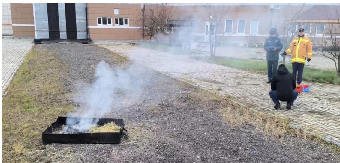
Рис. 3. Процесс измерения концентраций поллютантов вблизи модельного очага горения образца клевера лугового
