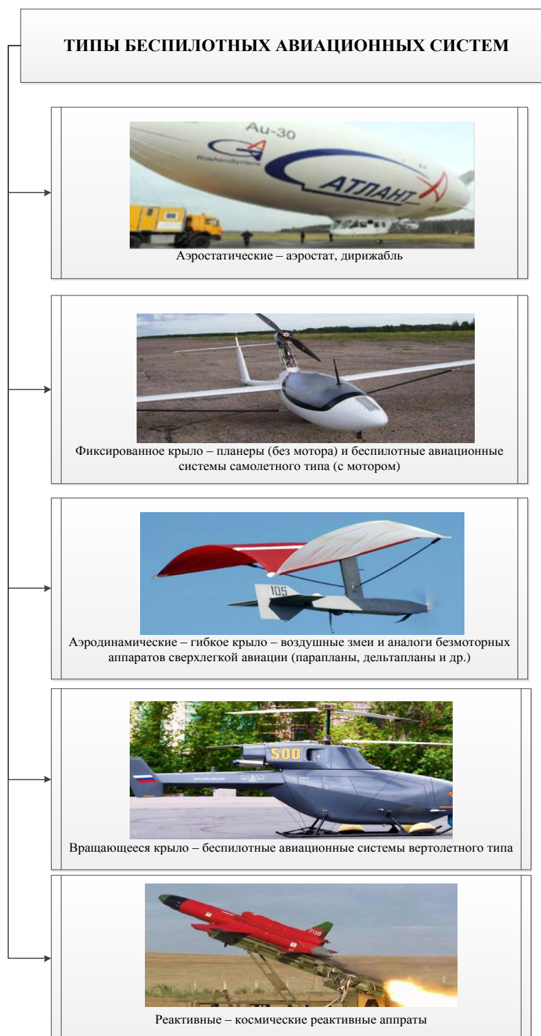
Рис. 6. Типы беспилотных авиационных систем
