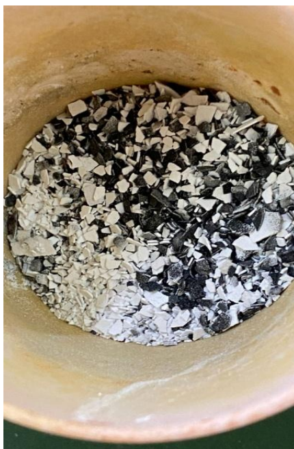
Рис. 6. Переходный этап от \text{CaCO}_3 к \text{CaO} (при температуре 518 °С и продолжительности прокаливания 3 ч)
