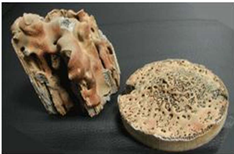
Рис. 4. Пример разрушения блока-носителя каталитического нейтрализатора при нештатном (аварийном) режиме [13]
