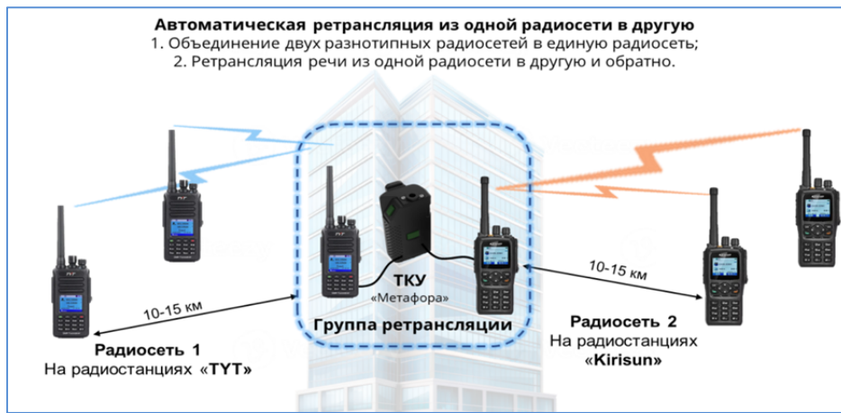
Рис. 3. Вариант размещения (вышка) при ретрансляции и сопряжения радиосетей
