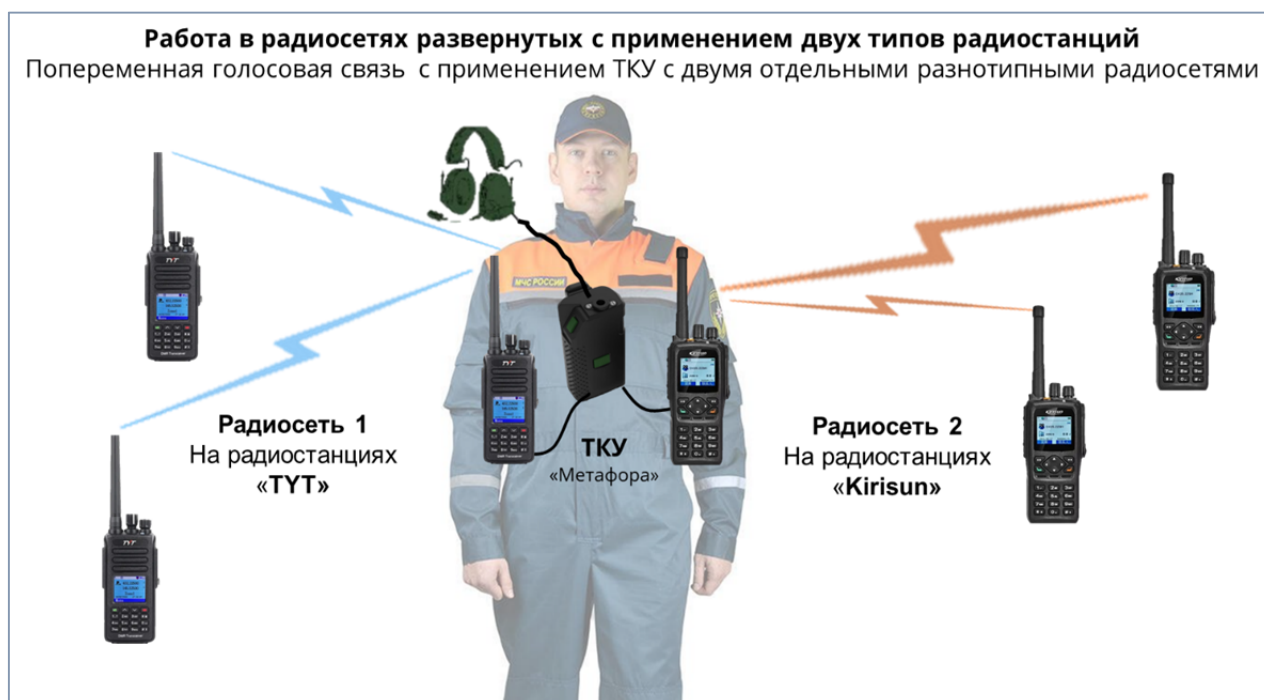
Рис. 2. Размещение ТКУ «Метафора» у командира подразделения для сопряжения двух радиосетей, развернутых на разнотипных радиостанциях
