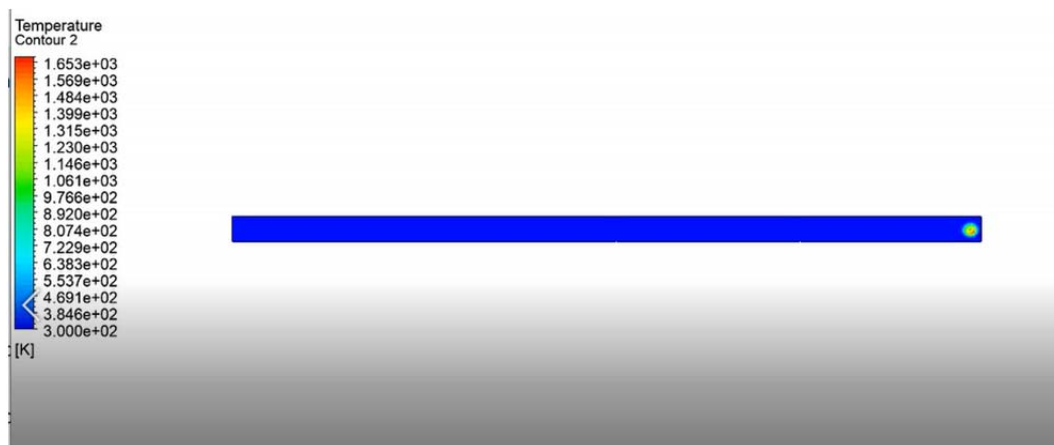
Рис. 1. Профиль поля температуры в меридиональном сечении трубы на стадии I (инициация горения, t \approx 0,01 с) процесса горения
