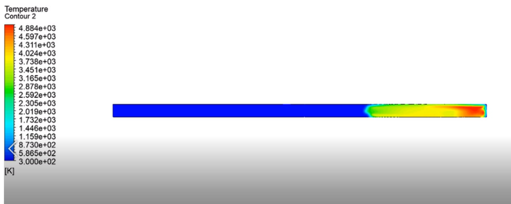
Рис. 2. Профиль поля температуры в меридиональном сечении трубы на стадии II (развитие горения у закрытого торца, t \approx 0,10 – 0,15 с) процесса горения
