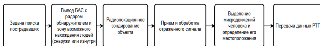
Рис. 7. Блок-схема применения радара-обнаружителя при проведении разведки
