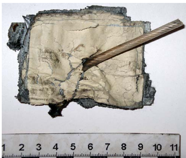
Рис. 1. Самодельное устройство, снабженное отрезком огнепроводного шнура
