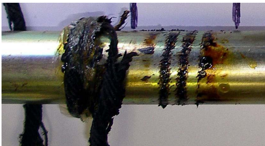
Рис. 4. Вид на остатки прогоревшего огнепроводного шнура типа ОША после технического исследования
