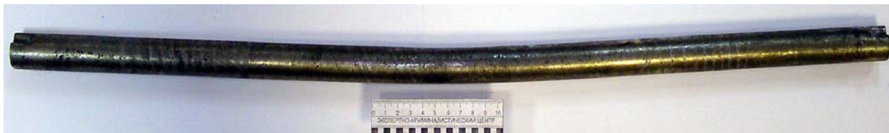
Рис 3. Представленная на экспертизу металлическая труба со следами применения средства передачи огневого импульса
