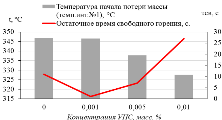
Рис. 5. Совмещенные данные значений температуры начала потери массы (температурный интервал № 1) и остаточного времени свободного горения образцов
