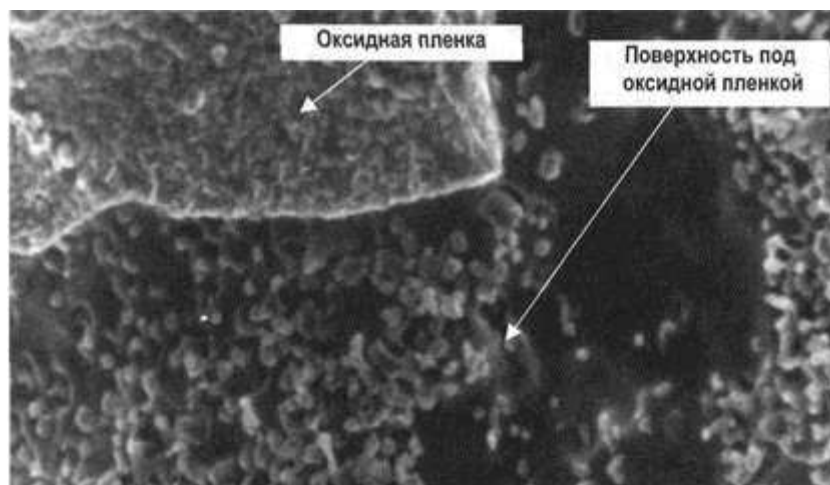
Рис. 6. Поверхность проводника на нагретом участке при отсутствии режима БПС
