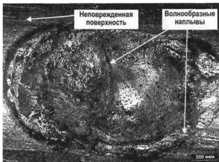
Рис. 4. Поверхность проводника с характерными волнами локального нагрева
