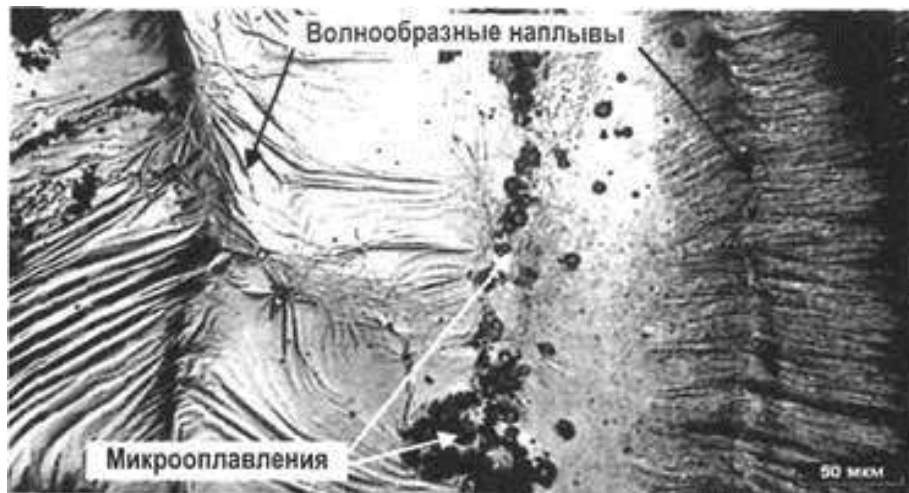
Рис. 5. Поверхность проводника со следами воздействия БПС. Комбинационный режим
