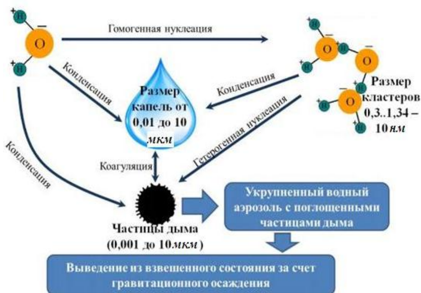
Рис. 2. Схема системы «пар–кластер воды–вода–дымовая частица» [8]
