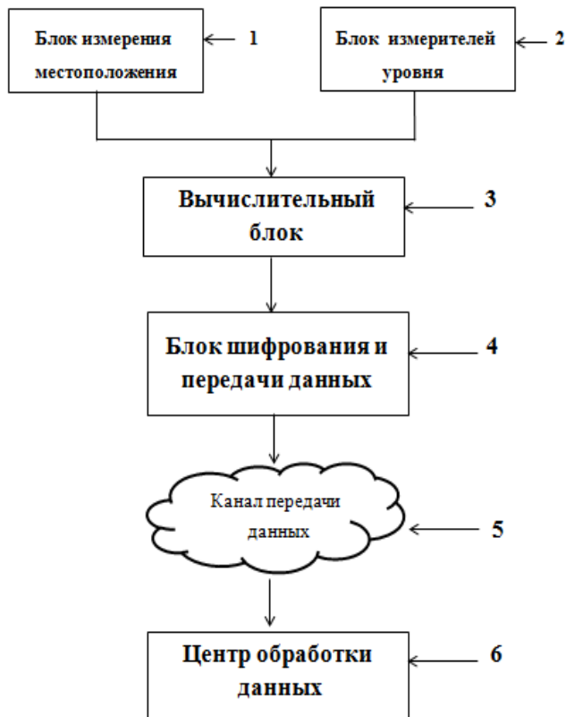
Рис. 1. Принципиальная схема способа оперативного определения массы пролитого ОХВ при частичной разгерметизации (разрушении) перевозимого резервуара с ОХВ
