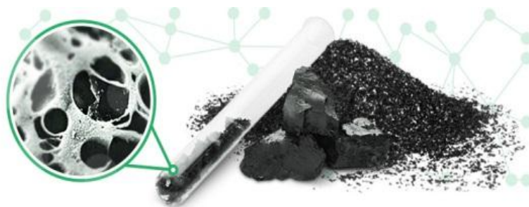
Рис. 2. Гранулы биологических сорбентов для ликвидации пленки разлива нефти и нефтепродуктов
