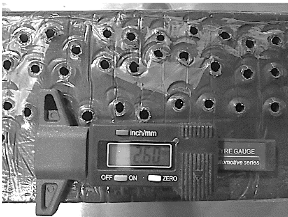
Рис. 2. Измерение глубины пробоин в преграде в ходе испытаний
