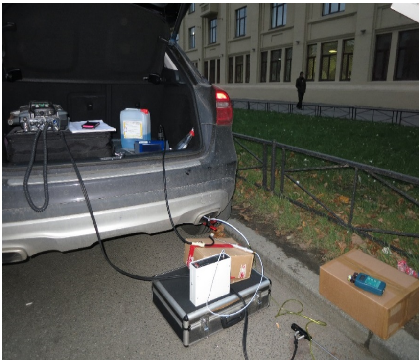
Рис. Экспериментальное исследование количественно-качественного состава отработавших газов легкового бензинового автомобиля Mercedes-Benz GLA 250 в реальных условиях эксплуатации (21 ноября 2015 г., температура воздуха – 0 °С)
