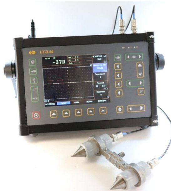
Рис. 5. Ультразвуковой дефектоскоп UCD-60 с игольчатыми ультразвуковыми преобразователями. Позволяет в режиме реального времени выводить информацию о характере прохождения ультразвуковой волны в массиве бетона
