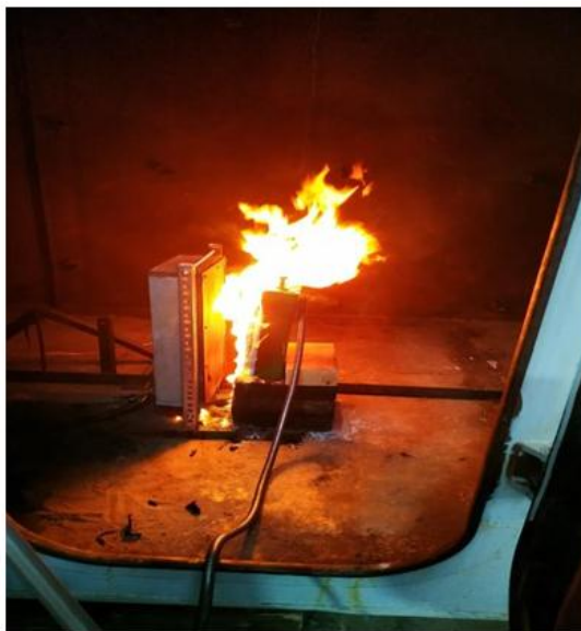
Рис. 3. Ячейка аккумулятора LT-LFP170В во время испытания
