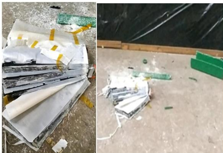
Рис. 5. Ячейка аккумулятора LT-LFP170B после испытания
