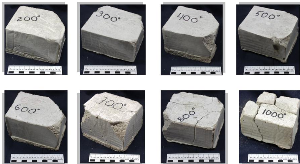
Рис. 2. Образцы бетона на основе марки цемента ПЦ 500-ДО-Н, обожженные при разных 1 температурах
