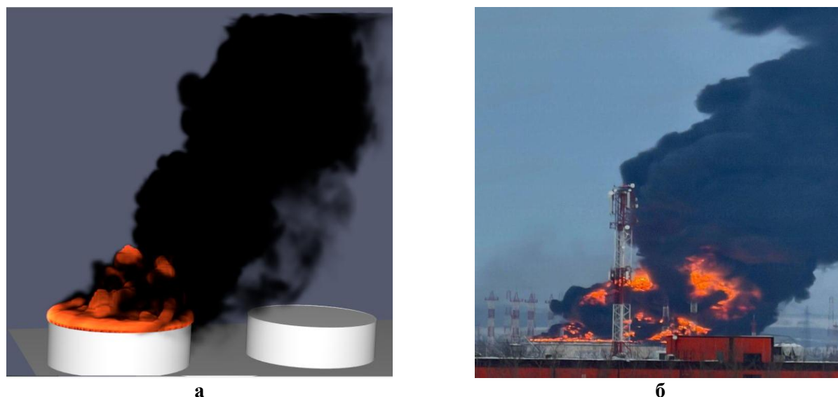
Рис. 1. Пожары в резервуарах: а – модель в FDS; б – фото реального пожара в резервуаре с нефтью объемом 50 000 м 3
