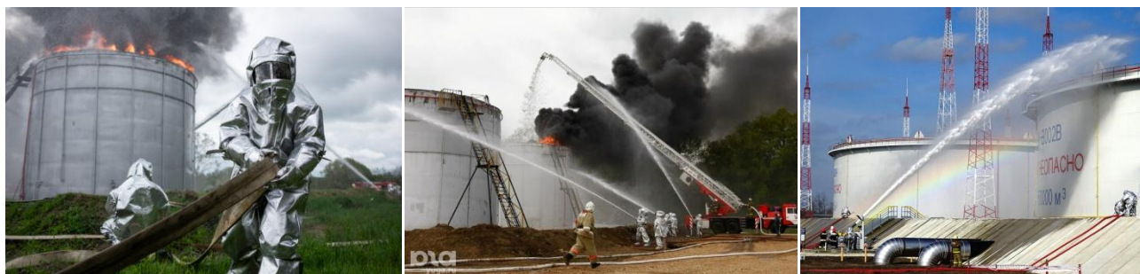
Рис. 3. Подача пожарных стволов на охлаждение стенок горящих резервуаров в СЗО
