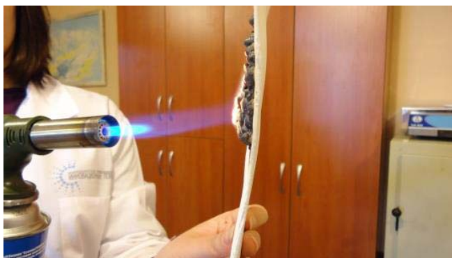
Рис. 7. Формирование защитного слоя в результате разбухания материала при воздействии огня
