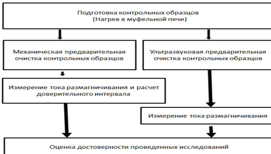
Рис. 4. Схема проведения исследований для оценки возможности использования УЗ очистки образцов
