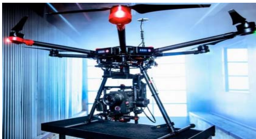
Рис. 4. DJI Matrice 600 – беспилотник для киносъемок
