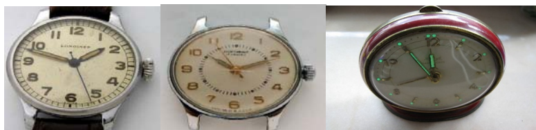
Рис. 7. Часы «спортивные» – стрелки почернели, фон 400 мкр/ч [3]. Справа будильник со светящимися точками около цифр
