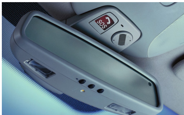
Рис. 1. Пример расположения кнопки «экстренный вызов» на автомобильной панели
